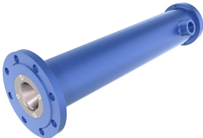
Высоконапорный генератор пены низкой кратности ВПГ предназначен для тушения пожаров в резервуарах с нефтью, нефтепродуктами и другими жидкостями. Подача пены осуществляется в слой горящего продукта, выше возможного уровня подтоварной воды. Данный тип пожаротушения называется подслоиным.
